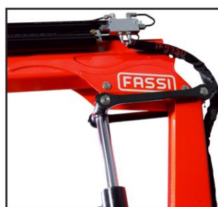
Рычажная система- Большая мощность, Вылет стрелы почти 7 метров!
